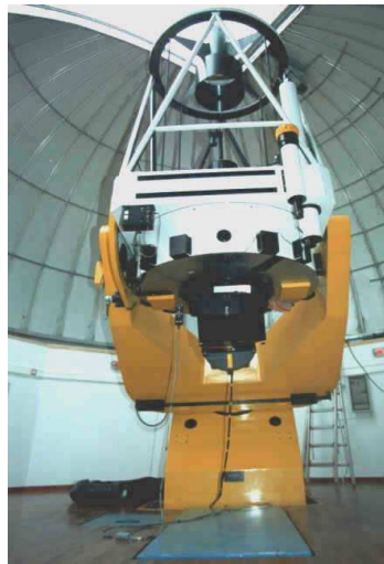
Εικ A.2 Το τηλεσκόπιο 1.3 μ τύπου Ritchey - Cretien του αστεροσκοπείου στο Σκίνακα.
