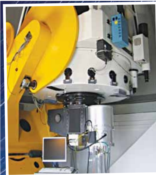
Η κάμερα κοντινού υπέρυθρου κάτω από το πτελεσκόπιο 1,3 μ. μέσα στον κρουσάτι της υγρού αζώτου, ο οποίος την κρατά στις απαραίτητες πολύ χαμηλές θερμοκρασίες.
